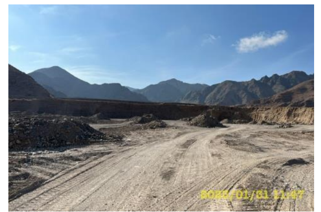
Фото 62 и 63. Лот 1. Карьер км 16+600. Требуется привести устойчивость бортов карьера в безопасное состояние, т.е угол наклона борта карьера д.б. равным 70°(не более).
