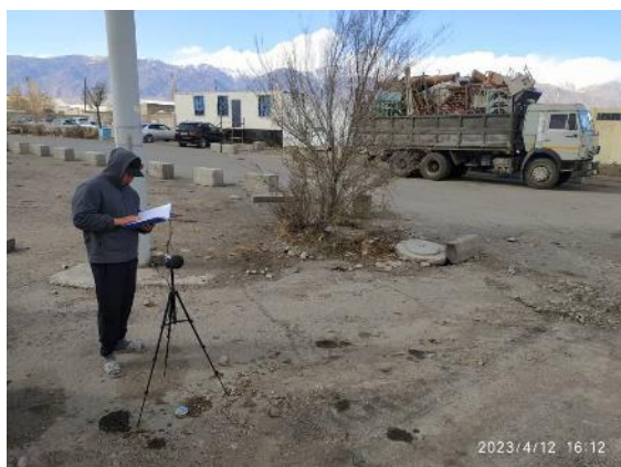
2023/4/12 16:12 Фото 112. Лот 1. Балыкчы, кольцевая. Замеры уровня шума и вибрации
